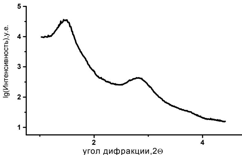
Рис 1. Кривые малоуглового рассеяния для образца коллоидного кристалла наноуглерода, отчищенного от \text{NH}_4\text{Cl} методом возгонки при 250\text{ C} .
